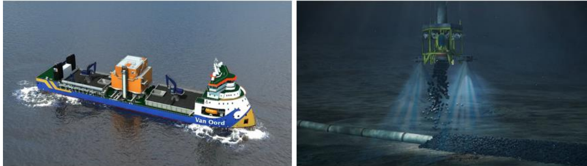
Figur 16 Til venstre: Illustrasjonsfoto av deponeringsfartøy. Til høyre: Illustrasjon av nedføringsrør/fallrørsystem med ROV
