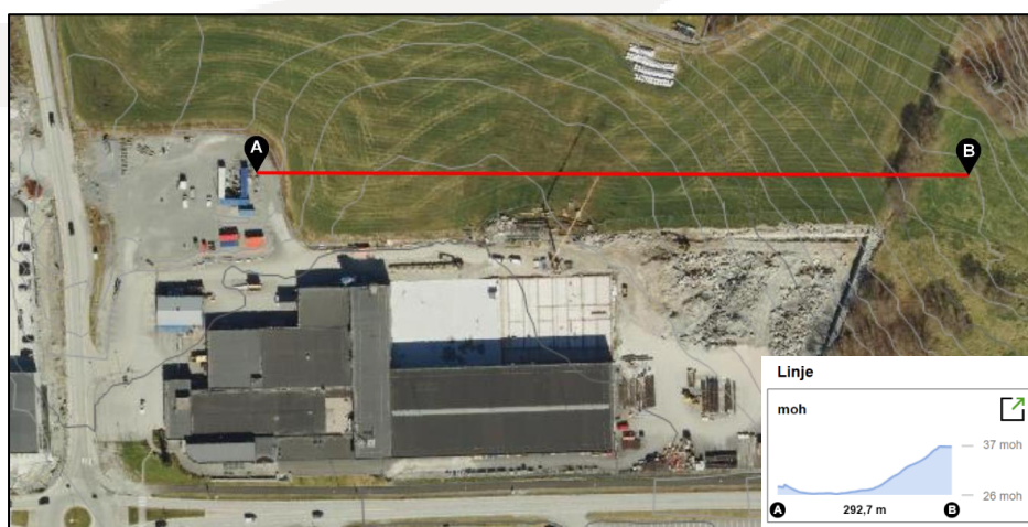
Figur 9: Viser høydekurver på 1 m og stigning på tvers av område
